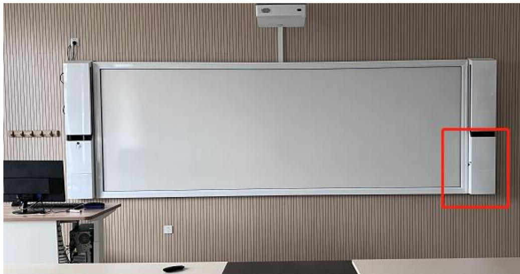
多媒体音量控制台，位于黑板右侧壁挂墙上的白色控制盒
