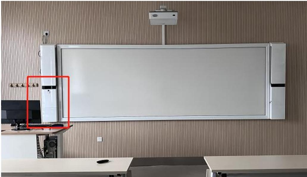
教室设备控制面板位于黑板左侧壁挂墙上的白色展台，教师可操作控制面板上按钮进行设备开关控制、及信号控制。
