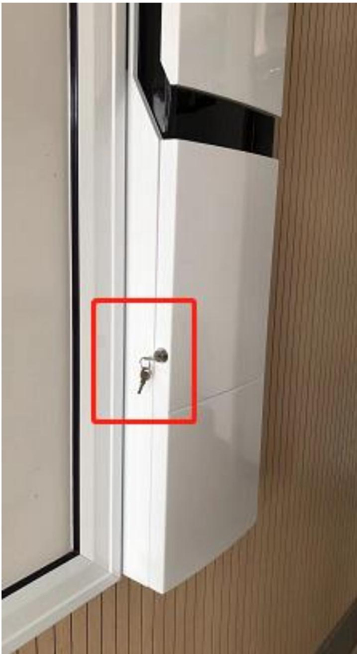
旋转外壳左侧的钥匙，手动拉开盖板
